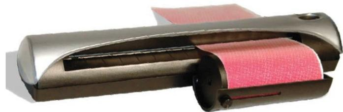
Die Darstellungen von Nip-Breite und Anpressdruck werden nach der Auswertung des Streifens in einfach lesbarer Weise durch das Programm dargestellt.
