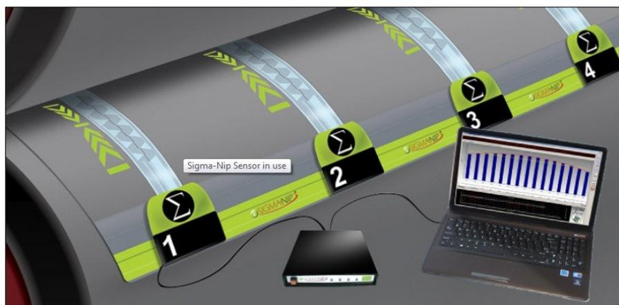
Die Windows basierte Software zeichnet die Nip-Breiten automatisch auf. Sie erscheinen sogleich in einer leicht interpretierbaren Weise auf dem Bildschirm. Der Anwender erkennt somit sofort, ob die Walzen richtig justiert oder abgenutzt sind.
