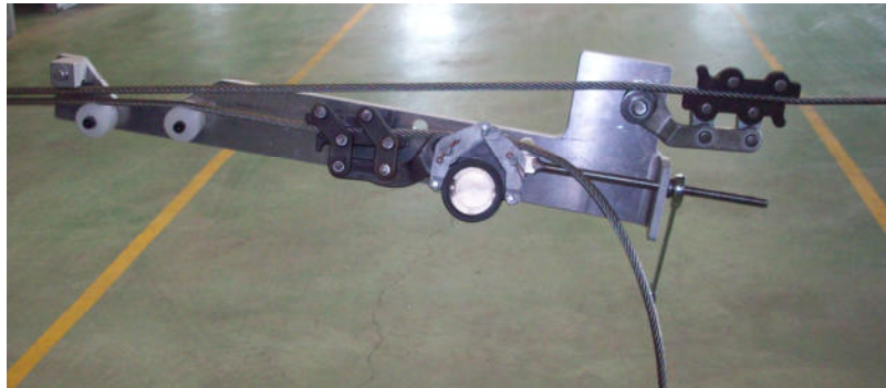
Y-Seilspannvorrichtung zum Spannen von Oberleitungen für Hochgeschwindigkeitszüge
