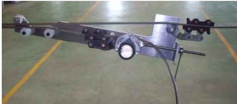
Y-Seilspannvorrichtung zum Spannen von Oberleitungen für Hochgeschwindigkeitszüge
